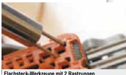
Flachsteck-Werkzeuge mit 2 Rastungen in den Entriegelungskanal einführen...
