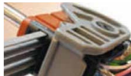
...entriegelten Kontakt aus dem Gehäuse entnehmen.
